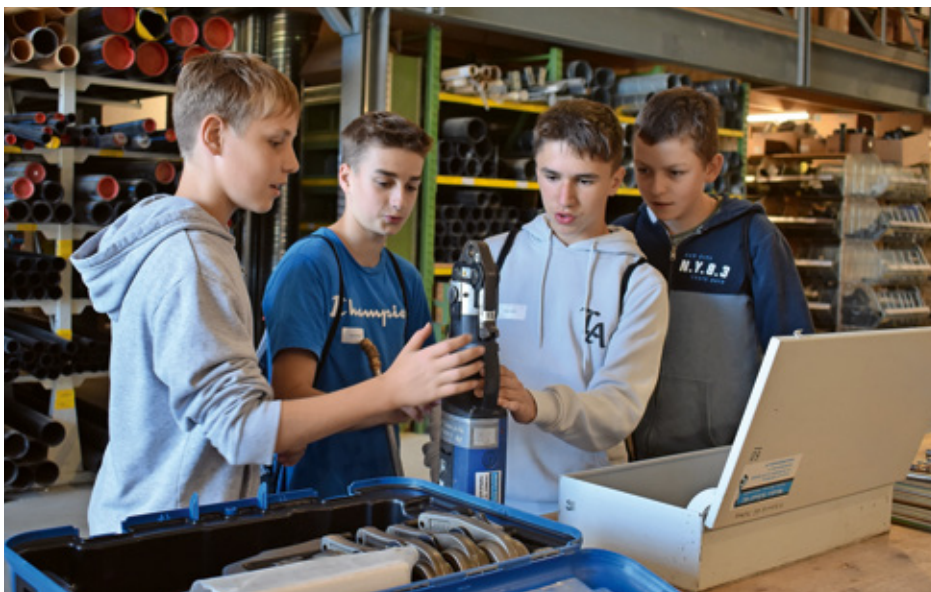
Mit dieser Pressemaschine werden Wasserleitungen gepresst, damit diese dicht sind. Bilder: zvg
